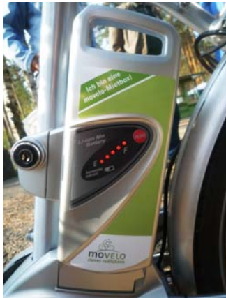
Abschließbarer Akku am Movel-Elektrofahrrad
